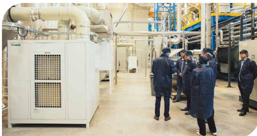
↑ Photo SGT © : Un groupe de visiteurs devant le refroidisseur, où les granulés subissent un dernier traitement pour éliminer l'acétaldéhyde, garantissant ainsi une pureté optimale du produit final.
