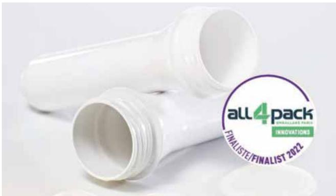
La formule ColorMatrix™ Lactra™ Four One Zero permet, en effet, de bloquer la lumière jusqu'à 99.9%, même avec une faible épaisseur de paroi (200 microns). Les produits laitiers, tels que le lait UHT, sensibles à l'oxydation sont ainsi protégés et conservés plus longtemps, jusqu'à 6 mois, sans altération du goût ou des propriétés sensorielles et nutritionnelles.
